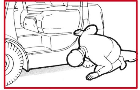
Verifique se há vazamentos de óleo, combustível ou líquido do radiador.
