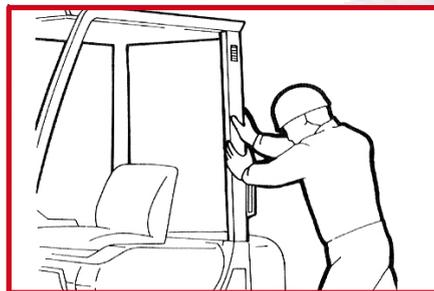
Verifique se o protetor do operador está alinhado e bem fixado. Balance o protetor para verificar se há parafusos soltos.
