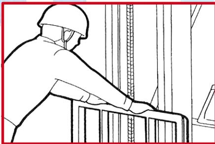
Verifique se o protetor da carga está desalinhado, torto ou com rachaduras.
