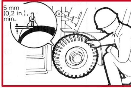
Verifique o estado dos pneus como cortes, rachaduras, sujeira nos sulcos, aros deformado ou quebrado.
